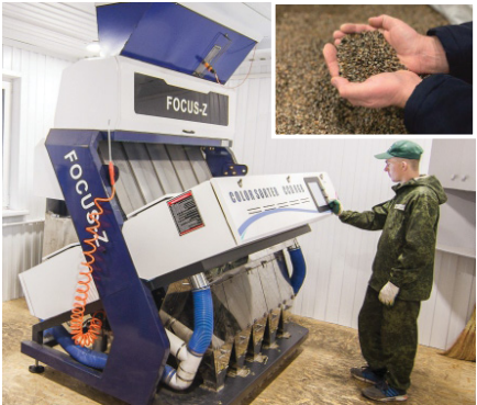
Семена гречихи проходят первичную очистку на воздушно-аспирационных машинах. Заключительный этап - оптический сортировщик. Семенной материал с чистотой 99,9% фасуется в Биг-Бэги и готов к отправке по всем регионам России и в Казахстан.
